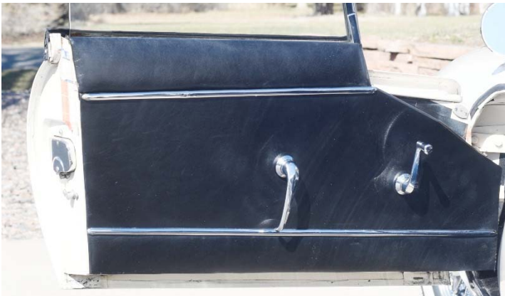
3.8L OTS door panel without door pull/arm rest
